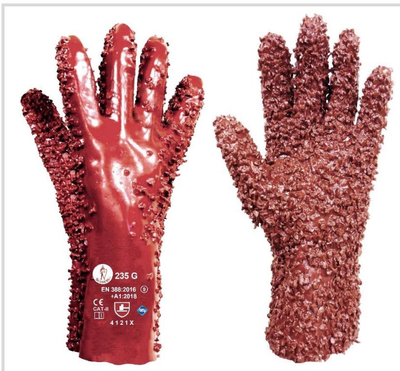
Guante recubierto de PVC doble capa con soporte en algodón interlock, granulado con virutas en la palma de la mano – Longitud 35 cm.
